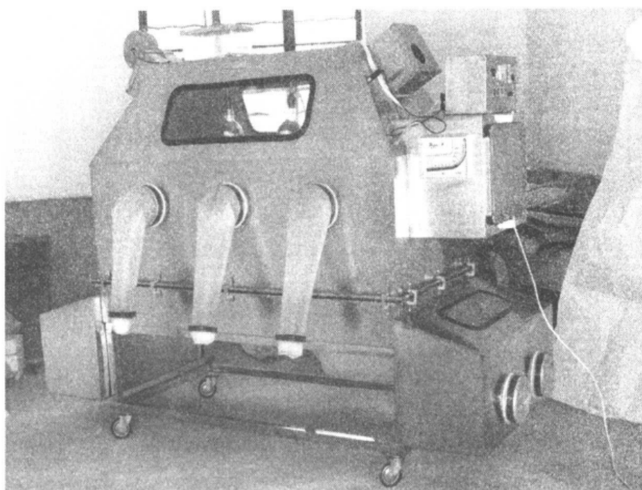
插图 5 II 型 SPF 鸡隔离器
