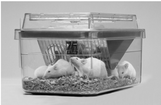
图 2-6 给啮齿类动物使用的静态的带过滤器盖的动物笼
