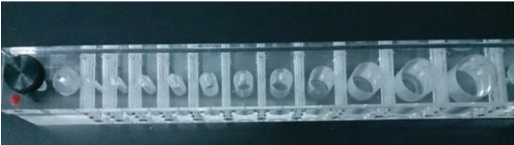
图 3 绝缘体校准容器 Fig.3 Insulated calibrating container
