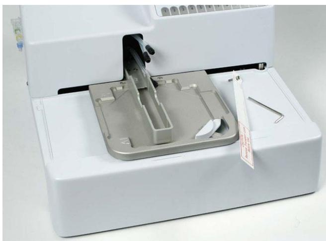
图 0-9. 取下运输锁和标签后
