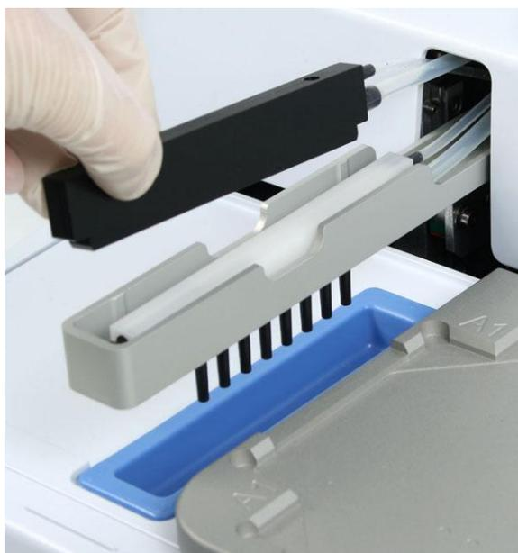
图 0-14. 在清洗臂左侧放置空白洗头
