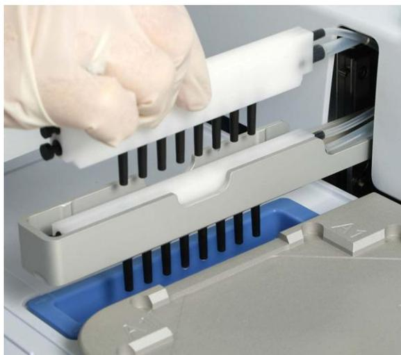
图 0-12. 将 2 x 8 的洗头并排装到清洗臂上
