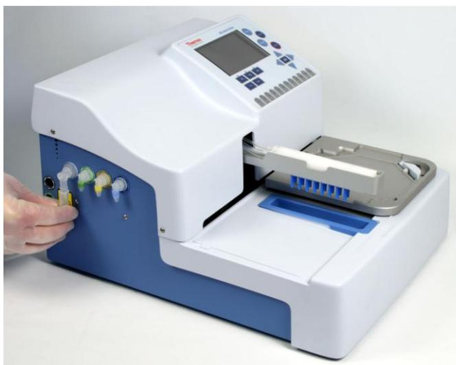
图 0-17. 连接洗瓶管道
