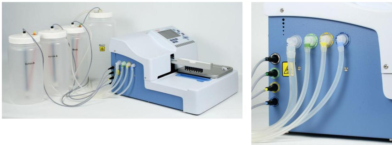
图 0-19. 洗瓶连接到仪器上
