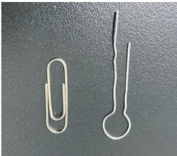
图 3 弯折曲别针制作后肢固定孔
