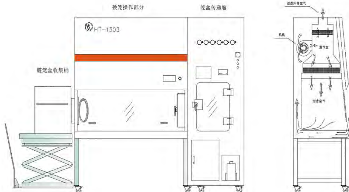
图1 自主研发生物安全型小鼠IVC换笼台的平面示意图
