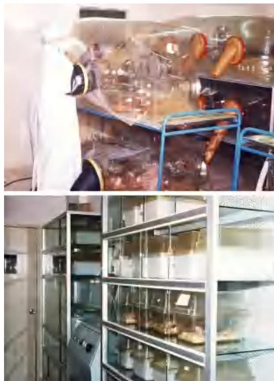
图2 20世纪80年代苏州市实验动物器材企业生产的第一代隔离器(上图)和国产超净生物层流架(下图)
